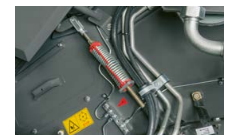
Alle Schmierpunkte sind zu zentralen Schmierleisten zusammengefasst und klar markiert.
