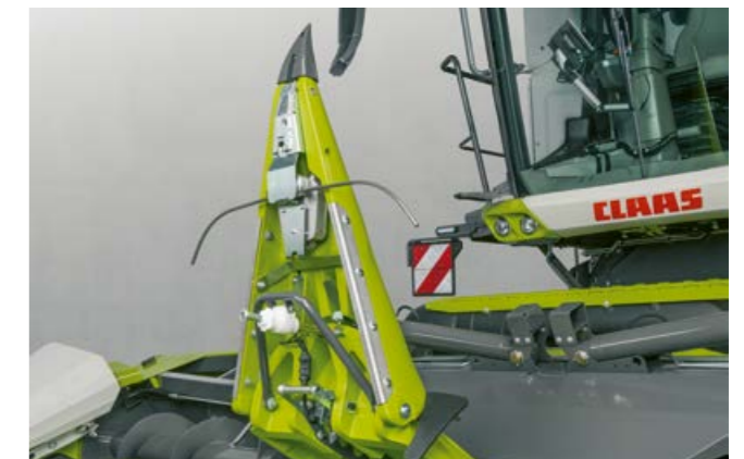
Zwei Tastbügel tasten je eine Maisreihe ab.
