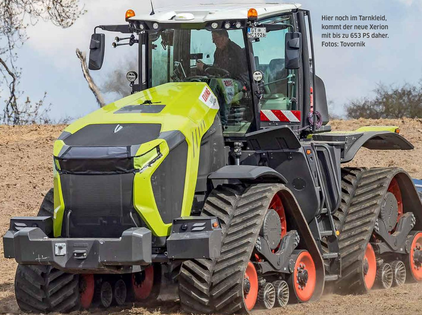
**B**ereits 2017 hat Claas die Entwicklung des neuen Xerion mit einer Befragung von Farmern weltweit gestartet. Dabei wurde deutlich, dass sich die Landwirte neben der Rad-unbedingt auch eine Raupen-Variante wünschen. Zum einen, um bei der Aussaat einen niedrigen Bodendruck realisieren zu können. Zum anderen, um bei der Bodenbearbeitung die Motorleistung in eine noch höhere Zugleistung umwandeln zu können.
