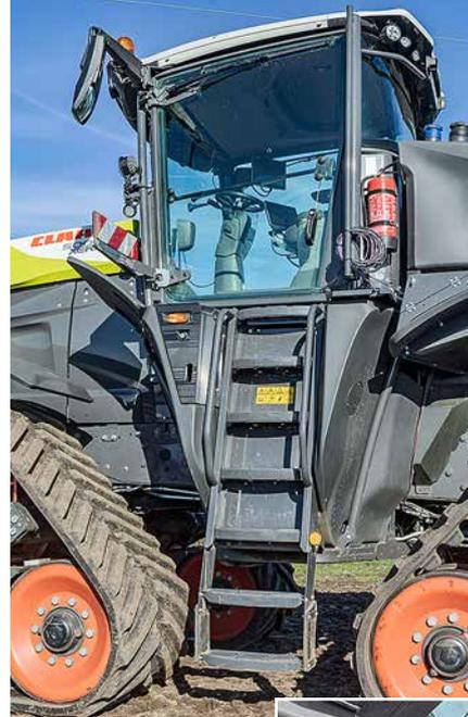
Wie beim Mähdrescher führt eine Leiter mit sieben Stufen in die Kabine. Die hat beim Xerion eine Vier-Punkt-Federung (Bild rechts).
