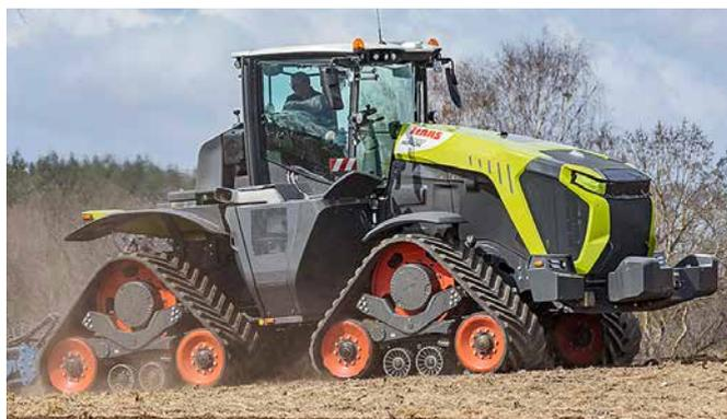
Der Sitz ist 40° drehbar, was die Sicht nach hinten erleichtert. Claas gibt 25,4 t Leer- und 32 t zulässiges Gesamtgewicht an. Ballastiert wird vorne und hinter dem oberen Tank.
