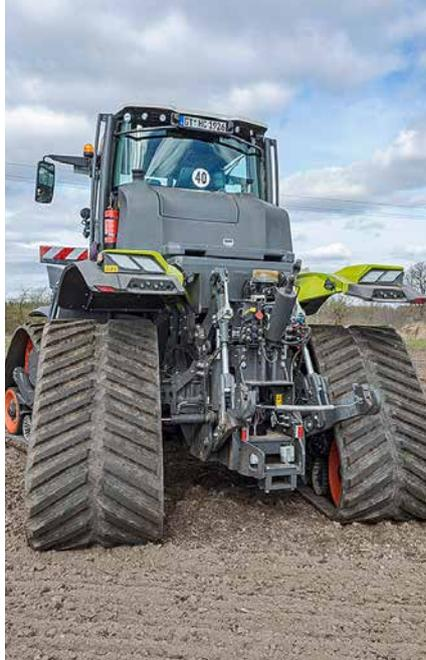
Mit optionalem Hubwerk ist der Lenkwinkel der hinteren Raupen begrenzt. 10 t durchgehende Hubkraft und bis zu 537 l/min Ölfördermenge verspricht Claas. Ob die maximal 1400 l Diesel (+ 90 l AdBlue) für lange Tage reichen, wird sich zeigen.
