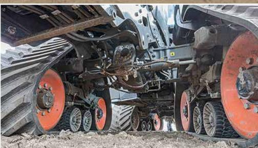
Die (hier noch mit Sensoren verkabelten) Achsen haben weiterentwickelte doppelte Lenkzylinder.
